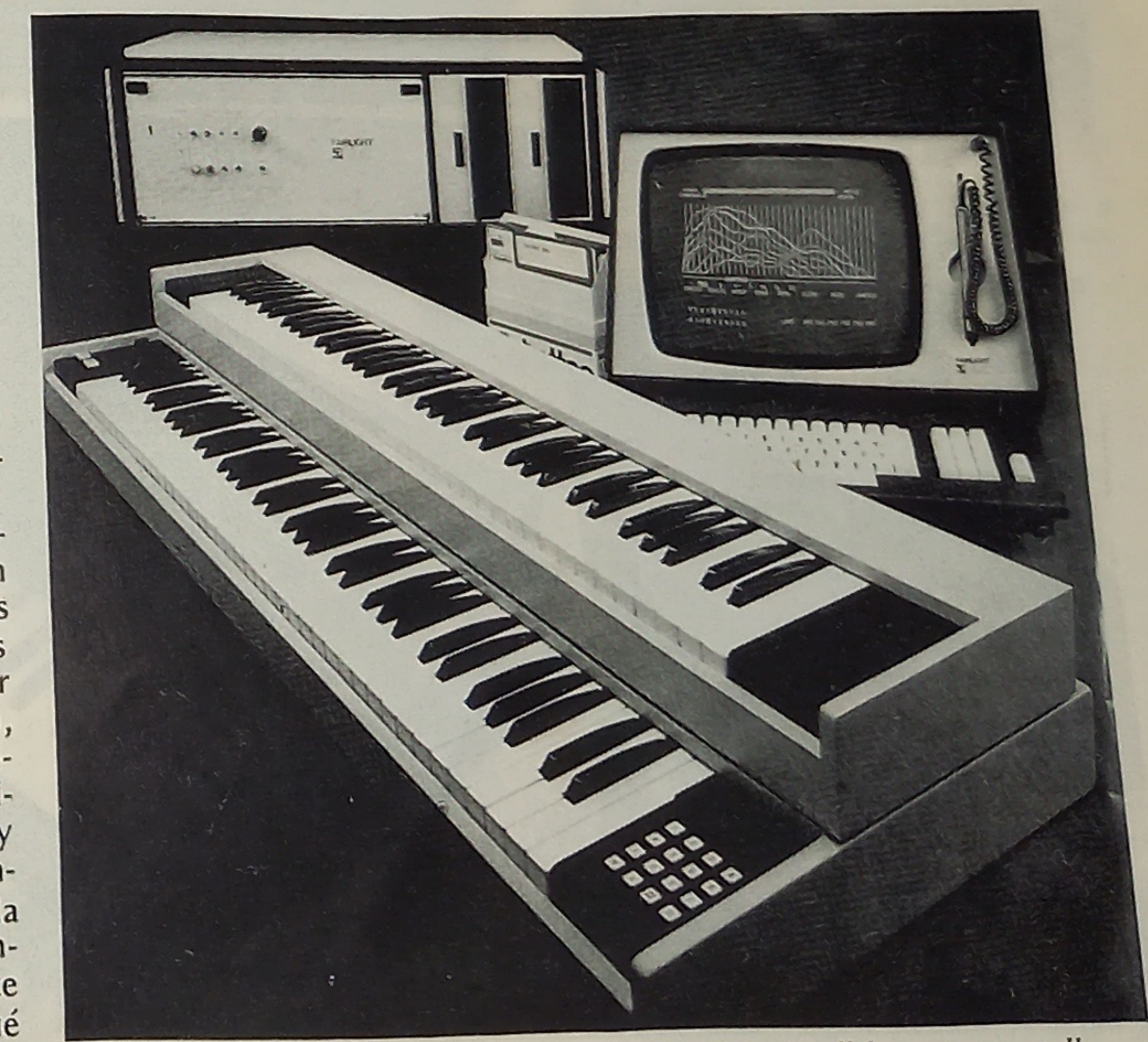
El teclado Fairlight CMI, es un sintetizador de síntesis aditiva, con pantalla que visualiza la señal y permite la creación de sonidos con un "lapiz" directamente sobre el tubo de rayos catódicos. El sueño de cualquier compositor.
