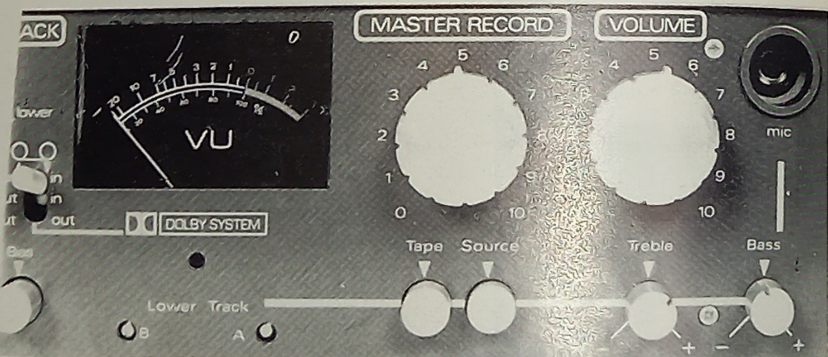
El Logic, posee en esta versión un doble circuito de reducción de ruidos Dolby, el mando "WIND", decide cual va a ser la dirección y la velocidad de bobinado. ¿Lógico?!!!
