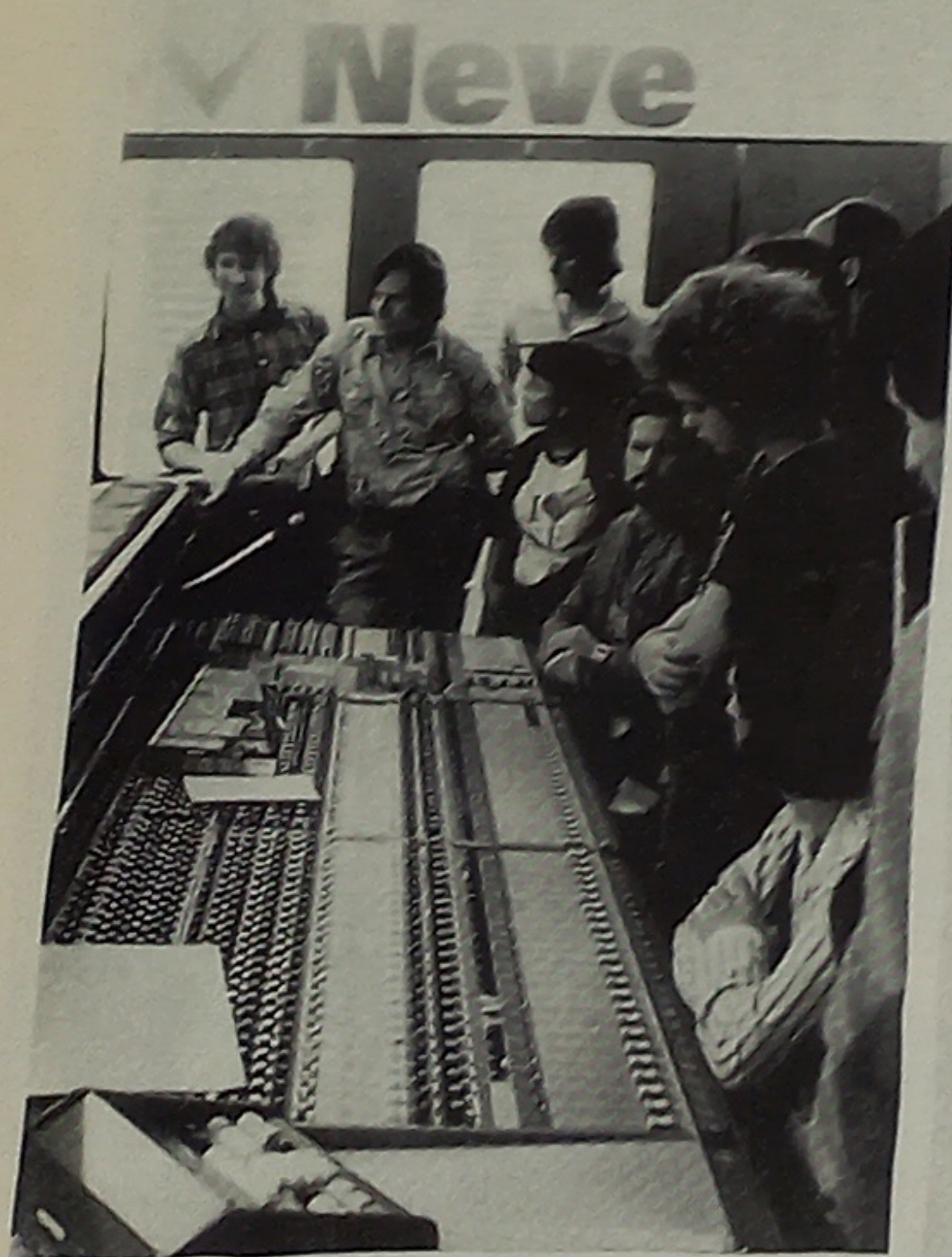
La nueva consola de Rupert Neve, posee un sistema automático, que controla el movimiento de los "faders".
