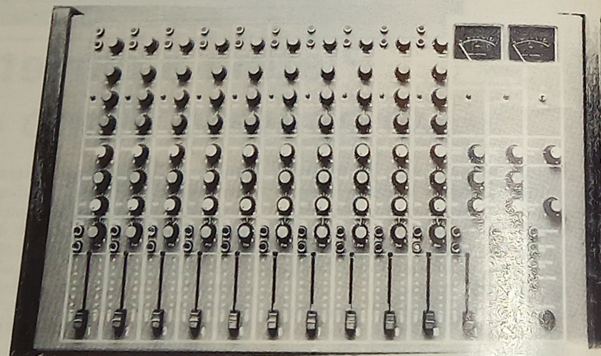
Mesa de mezclas HUDSON CSL 1002. Diez canales de entrada, dos de salida, tres controles de tono por entrada, controles para eco y reverberación por canal, ganancia de entrada graduable en continuo, dos salidas auxiliares, control de monitor "SOLO" por canal.
